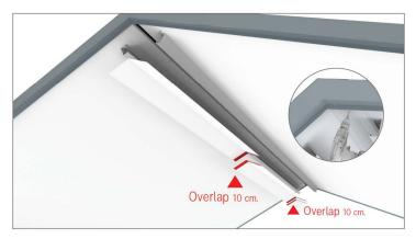
ติดตั้งครอบจั่วล่าง ที่จุดเชื่อมต่อทำการติดตั้ง Overlap 10 เซนติเมตร ยึดครอบจั่วล่างด้วยสกรู FS-T ของอาควาไลน์ โดยเว้นระยะห่างใน แต่ละจุด60 เซนติเมตร
