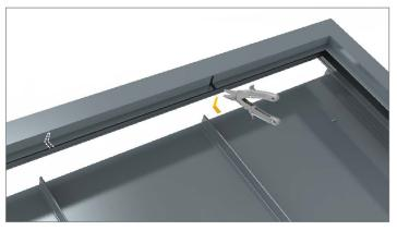
ทาบแฟลชชิ่งครอบปลายด้านบนหลังคา ระบุตำแหน่งและวัดขนาด ของสันซีมหลังคา ตัดออกให้เกิดเป็นร่อง เพื่อสวมเข้ากับปลายของ หลังคา
