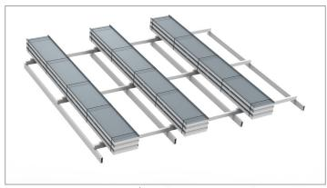
การวางแผ่นบนโครงสร้างเพื่อติดตั้ง ต้องทำการติดตั้งแผ่นโฟมรอง ที่โครงสร้างก่อนยกแผ่นมาวาง เพื่อป้องกันรอยขีดข่วนที่จะเกิดใต้ ท้องแผ่น ไม่ควรวางซ้อนแผ่นเกิน 3 แผ่น และต้องทำการยึดรัด ้เข้ากับโครงสร้างอย่างแน่นหนาระหว่างรอการติดตั้ง
