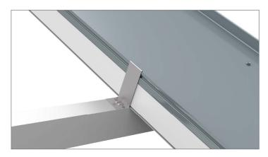
้ ติดตั้งตะขอ CLIP LOCK ของอาควาไลน์ เข้ากับแปด้วยสกรู B08 (สำหรับ \*กรณีองศาหลังคาน้อยกว่า 10 องศา หรือการใช้ผลิตภัณฑ์ในที่ แปเหล็ก) หากกรณีแปไม้ให้ใช้สกรูที่ยาวกว่าสกรู B08 เพื่อให้ตะขอ โล่งแจ้ง หรืออาคารสูงที่มีลมพัดแรง ต้องยิงซิลิโคน 100 % บนสันโค้ง CLIP LOCK ของอาควาไลน์ ทำหน้าที่ล็อคแผ่นหลังคาเข้ากับโครงสร้าง บนซีมตัว I ( ตามภาพ ) โดยที่ขนาดเส้นซิลิโคนต้องไม่น้อยกว่า หลังคาอย่างมีประสิทธิภาพ
