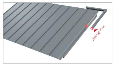
ติดตั้งแฟลซชิ่งครอบข้างชิ้นต่อไป โดยจุดเชื่อมต่อของแต่ละชิ้น ทำการติดตั้ง Overlap 10 เซนติเมตร ในกรณีหลังคา Flat Slab Modern ดังรูป จะใช้แฟลชชิ่งครอบข้าง หักมุมไปครอบปลายหลังคาด้านบน
