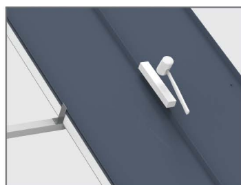
ใช้ค้อนไฟฟ้าขันนอตตะเข็บหลังคาเพื่อล็อก แผ่นหลังคาแผ่นแรกและแผ่นถัดไป
