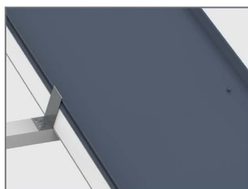
ยึดตะขอเข้ากับแผ่นหลังคา และยึดเข้ากับแป
