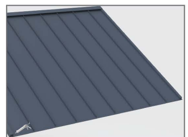
ติดตั้ง Flashing และยิงซิลิโคน เก็บความเรียบร้อย
